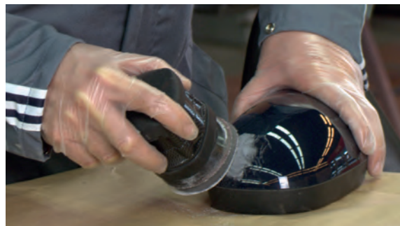
Lijado de arañazo con esponja abrasiva.
