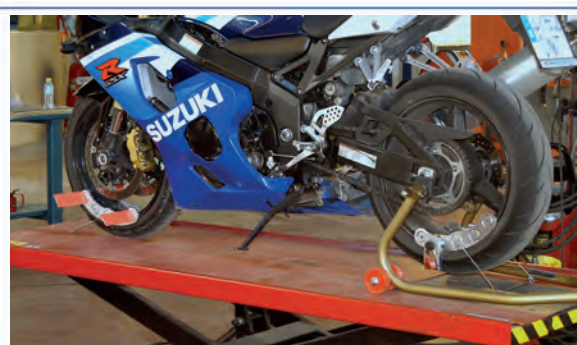
8 Medición del paralelismo o alineación, entre la rueda delantera y la trasera.
