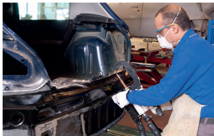
Unión por soldadura.
