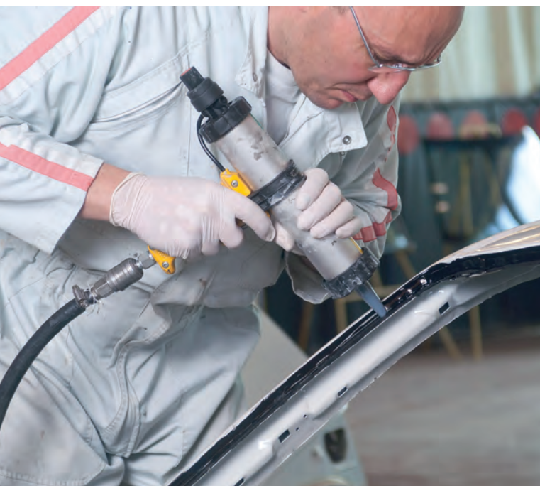
La luna parabrisas se une a la carrocería mediante adhesivo.
