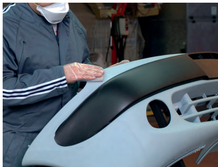
Matizado de la imprimación-aparejo de origen.
